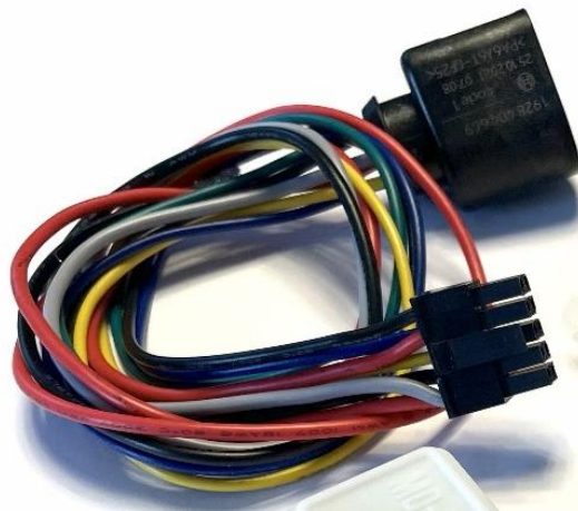
Verbindungskabel zur Lambdasonde und der Stromversorgung
