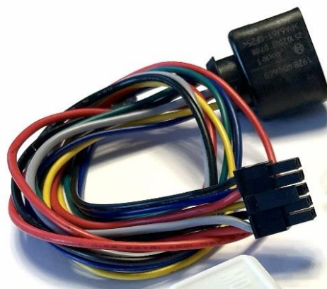
Verbindungskabel zur Lambdasonde und der Stromversorgung
